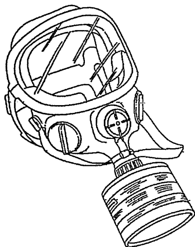
Ejemplar de un respirador de bote o "careta de gas," un tipo de respirador TC-14G MSHA/NIOSH.
