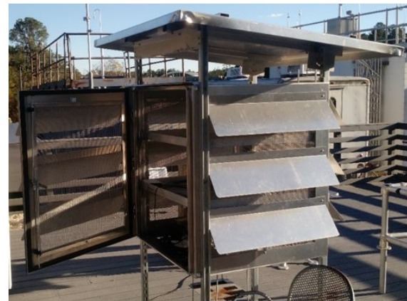
Ejemplo de un refugio contra la intemperie fabricado especialmente para la evaluación del sensor.
