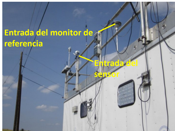
Ejemplo de entrada del sensor situada cerca de la entrada del monitor de referencia.
