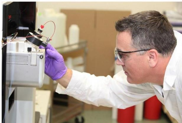
Mark Strynar, de la Oficina de Investigación y Desarrollo de la EPA, supervisa un espectrómetro de masas de alta resolución mientras realiza un cribado no específico de PFAS emergentes.
