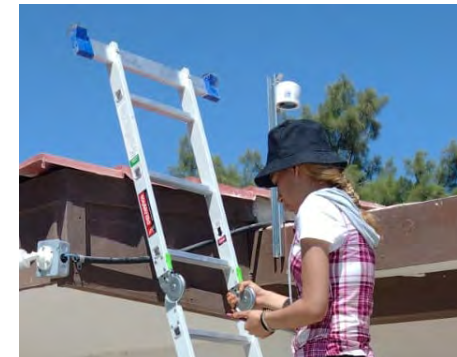
Se tiene en operación 70 sensores instalados en la ciudad y su valle para la medición de la calidad del aire para partículas PM 2.5
